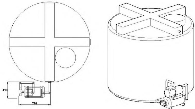
*Вариант Б (оборудование устанавливается на полу).*
