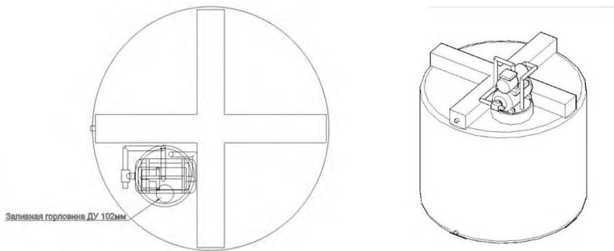
*Вариант А (оборудование крепится на специальной крышке).*
